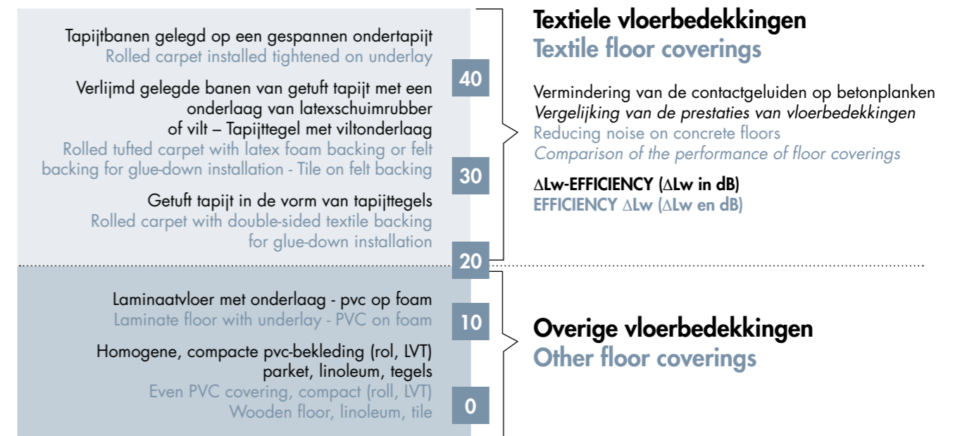
Vergelijking van de prestaties van vloerbedekkingen (contactgeluiden op betonplanken) Comparative performances of floor coverings (impact noises on concrete floor)
